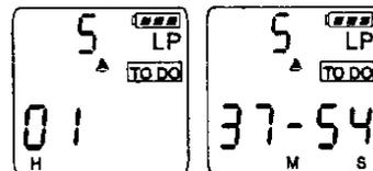
A. Σε θέση αναμονής (Standby) πατήστε FF/SCAN για να τεθείτε στη λειτουργία TIME (ώρα) και REW/REP για τη λειτουργία μηνυμάτων (MSG).
