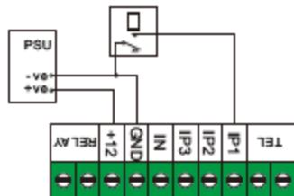
Σύνδεση του τηλεφωνητή για διέγερση με σήμα χαμηλής στάθμης NC
